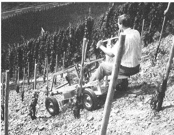
Abb. 6: Steillagenmechanisierungssystem der Firma Clemens (Seilzuggestützt)
