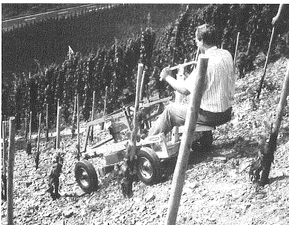
Abb. 6: Steillagenmechanisierungssystem der Firma Clemens (Seilzuggestützt)
