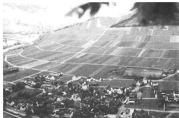
Abb. 26: Hangparallele Gürtelwege im Flurbereinigungsverfahren Ernst
