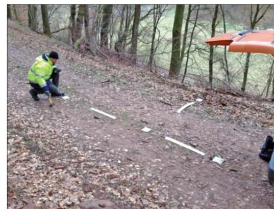
Abb. 14: Signale eines Aufnahmepunktes mit Sicherungspunkten
