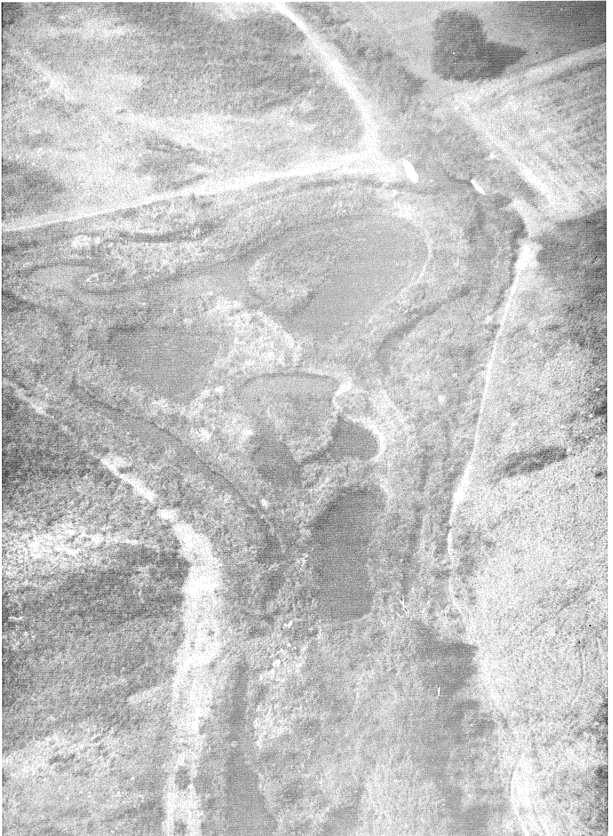
Abb. 2: Biotopgestaltung mit Wasserflächen und Wasserläufen sowie Hochwasserrückhaltefunktion; gelungene naturnahe Gestaltung.
