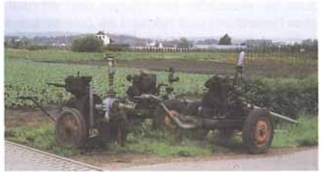
Beregnung früher: Mit Hilfe von Dieselmotorpumpen wurde das Wasser zur Beregnung aus 105 Flachbrunnen gefördert.
