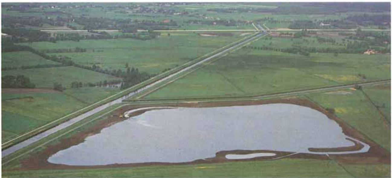
Das Unternehmen benötigt für einen 18 km langen Bauabschnitt 2,5 Mio cbm Sand als Unterbau für die Fahrbahn, gleichzeitig waren 0,6 Mio cbm nichttragfähiger Boden abzulagern. Es gelang, in 2 km Entfernung von der Trasse eine zentrale Sandentnahmestelle von 19 ha bereitzustellen.
