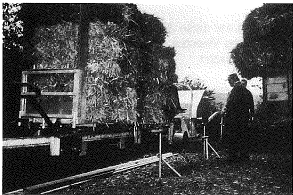
Abb. 4: Beladen einer Monorackbahn im "Bahnhof" des Steillagenweinbergs
