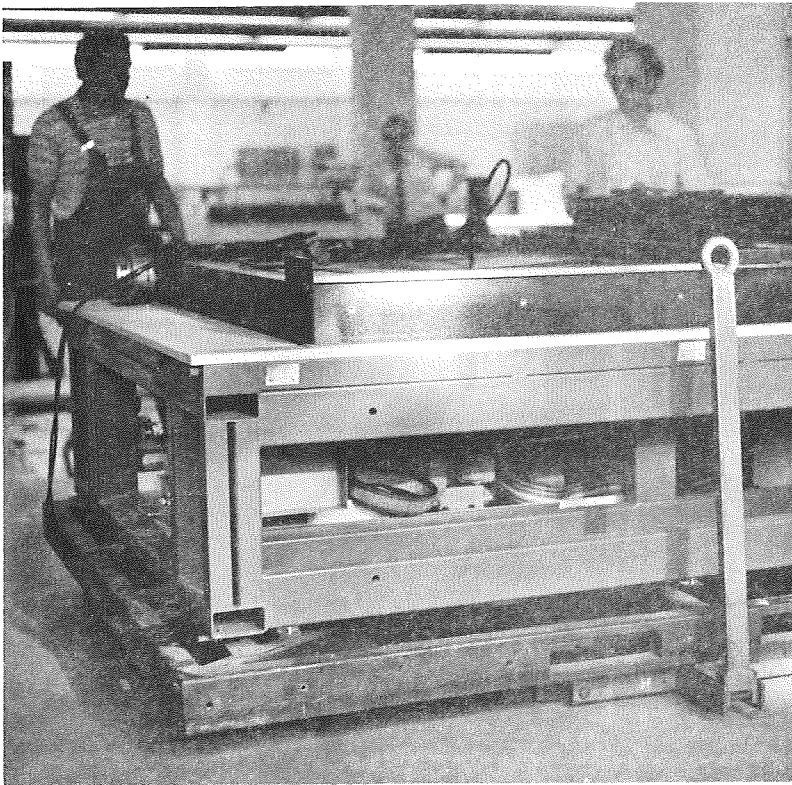
Abb. 2: Aussonderung der Calcomp - Präzisionszeichenanlage 745 - Hydraulisches Anheben der 3-Tonnen-Anlage im Maschi- nensaal der Luftbild- und Rechenstelle
