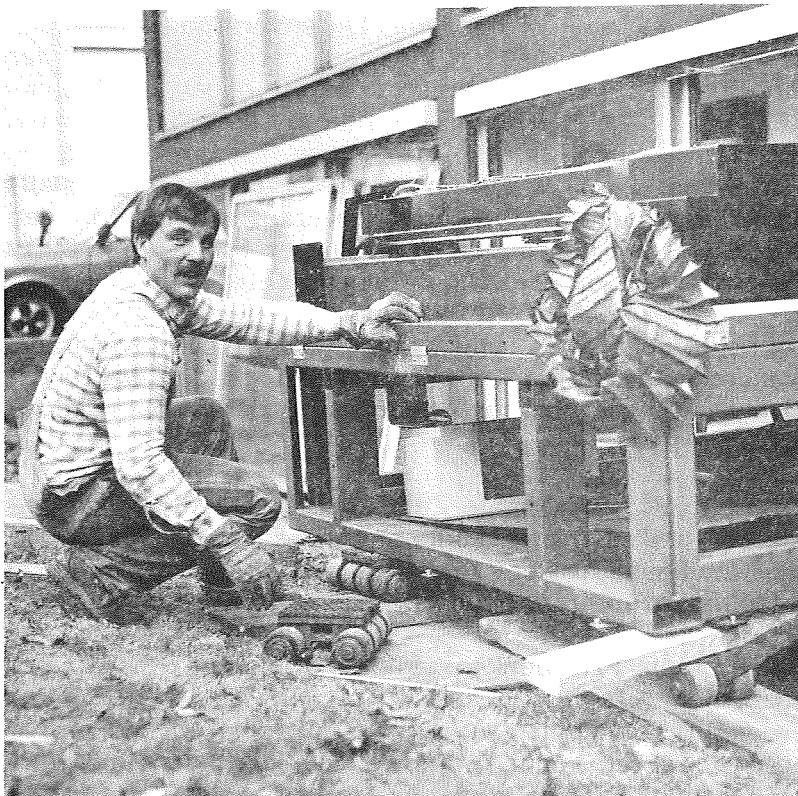
Abb. 3: Calcomp - Präzisionszeichen- anlage 745 unmittelbar vor dem Abtransport durch die Computerverwertungsgesell- schaft - Schubbewegung auf Gleitrollen durch das Fen- ster des Maschinensaaes
