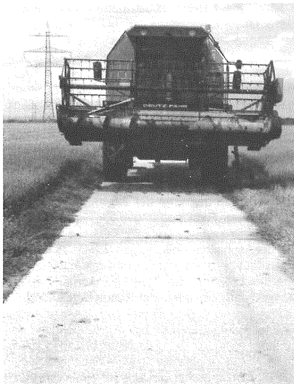
Abb. 3: Mähdrescher mit 3 m Breite über den Rädern auf einem Betonweg
