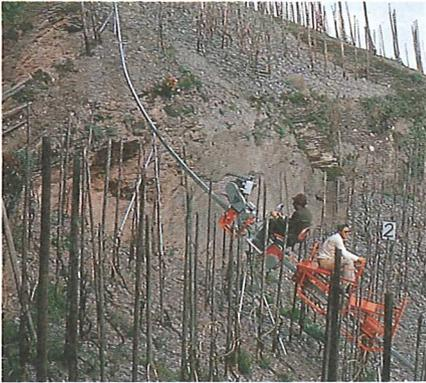
Zur Erschließung von Weinbergterrassenanlagen mit über 60% Gefälle, in denen Planierungen nicht mehr erfolgen können, können Einschienenbahnen (mit Personentransport) oder Zweischienebahnen (ohne Personentransport) gebaut werden. Eine Kombination von Fahrwegen mit Schienenbahnen ist eine optimale Erschließung dieser steilsten Weinbergflächen, ohne das Landschaftsbild oder den Landschaftshaushalt der Weinberge nachhaltig zu beeinträchtigen.
