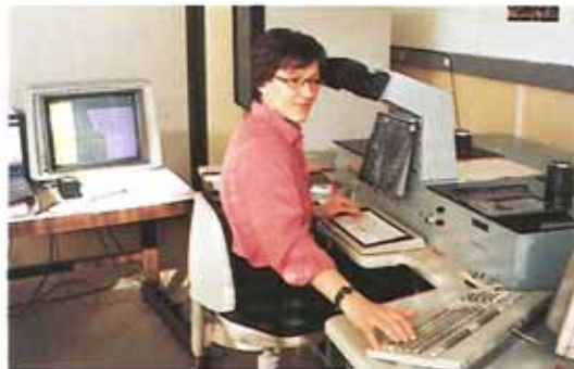
Abb. 14: Mit Hilfe photogrammetrischer Auswertungen werden Planungsunterlagen hergestellt und Grenzpunkte vermessen.
