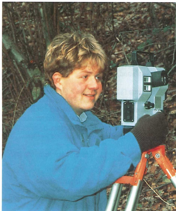
Abb. 38: Um den Grundstückseigentümern die Grenzen der neuen Grundstücke in der Örtlichkeit anzei-gen zu können, sowie zur dauerhaften Siche-rung mit Grenzmar-ken, werden Grenzen in die Örtlichkeit übertragen. Dies ge-schieht mit modern-sten Meßmethoden.
