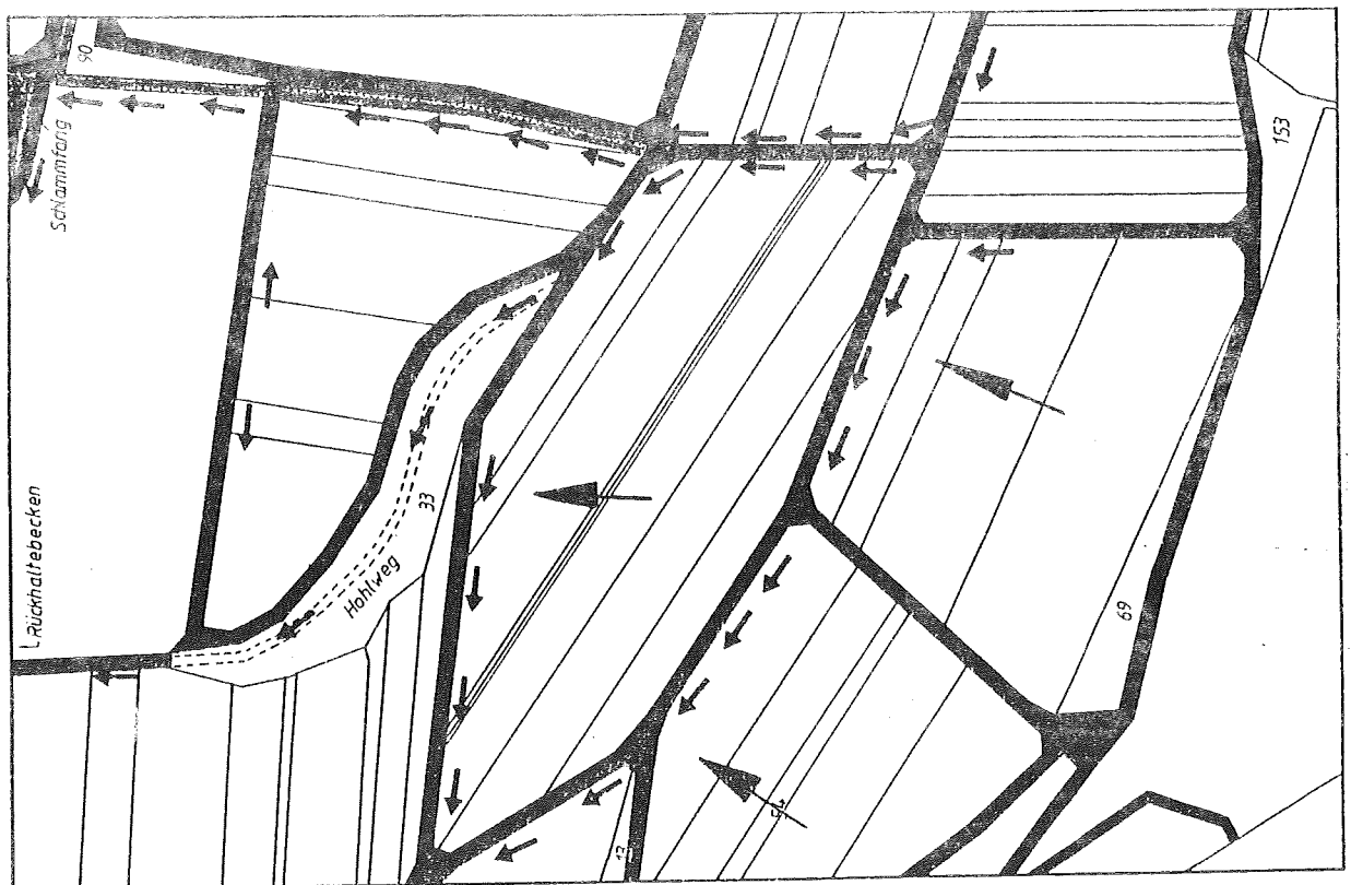
Abb. 14: Wasserführung nach der Flurbereinigung
