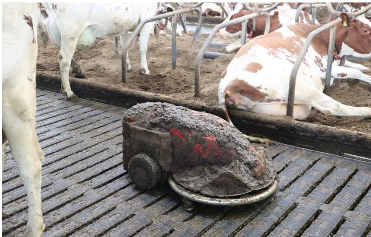
Abbildung 1: Spaltenroboter auf perforiertem Boden mit Profil und Dichtungsklappen
