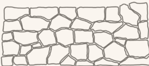
Abbildung 21: Zyklopenmauerwerk
