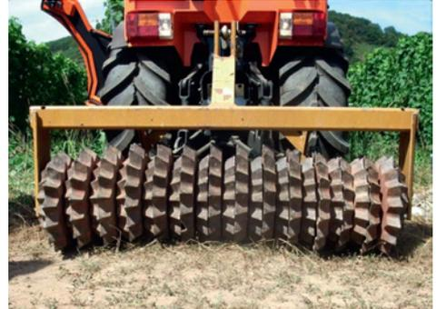
Prismenwalze mit festen und losen Scheiben für eine optimale Bodenanpassung
