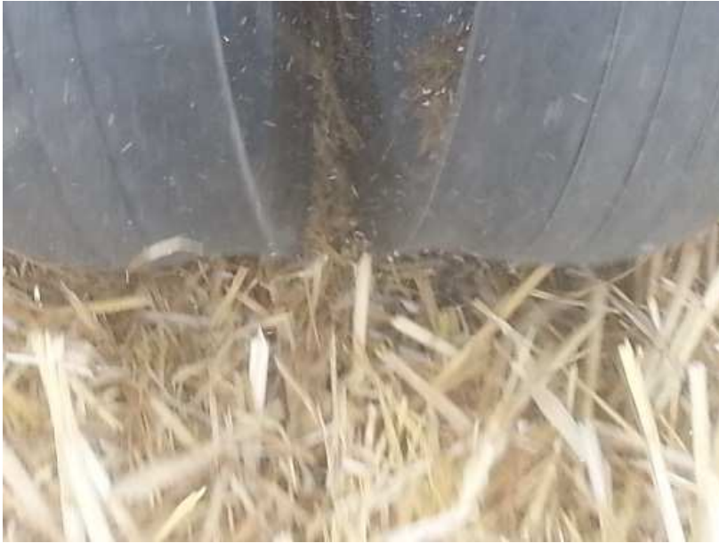
Abbildung 3: Die Andruckrollen verschließen die Saatrille wieder
