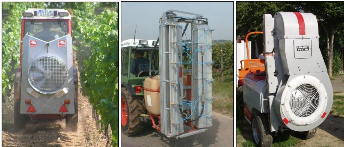
Abbildung 70: Axialgebläse mit Luftleitsystem (links), Tangentialgebläse (Mitte), Diffusor-Radialgebläse (rechts) (Bäcker, 2009)
