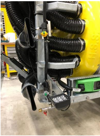
Detailbilder des PWM-Moduls und der Düsen
