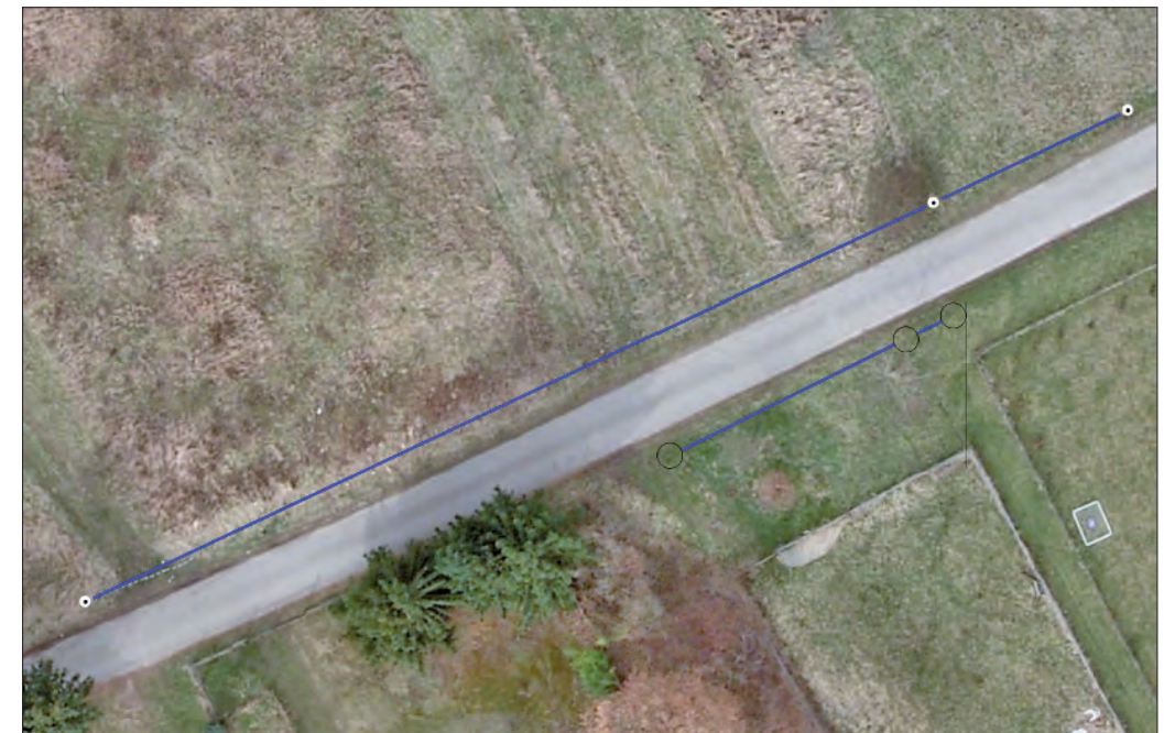
Bild 2: Punktbestimmung im Stereomodell
