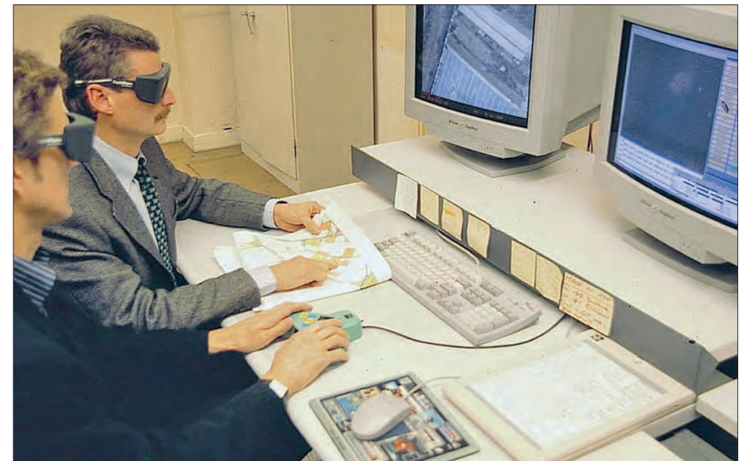
Abbildung 7: Der digitale Stereoplotter Zeiss PHODIS ST 30 ist vielseitig einsetzbar. (Quelle: Fehres)
