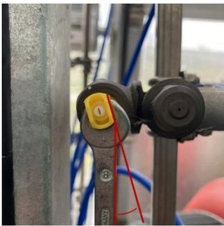
**Abbildung:** Sachgerechte Positionierung einer Injektor-Flachstrahldüse
